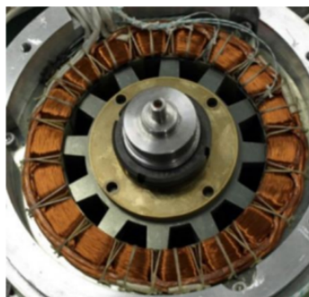
Obrázek 5.5: Spínaný reluktanční motor s vnitřním rotorem, převzato [30]
